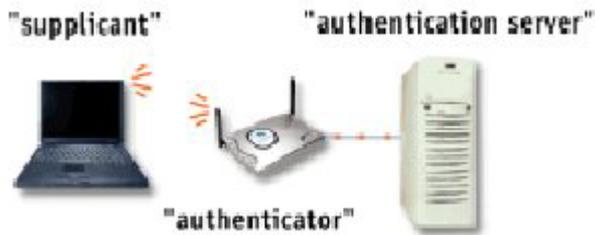
Il processo di autenticazione si può così riassumere: quando una stazione client (**supplicant**) tenta di accedere ad una WLAN tramite 802.1x, l'AP abilita il passaggio solo del traffico di autenticazione forzando la
